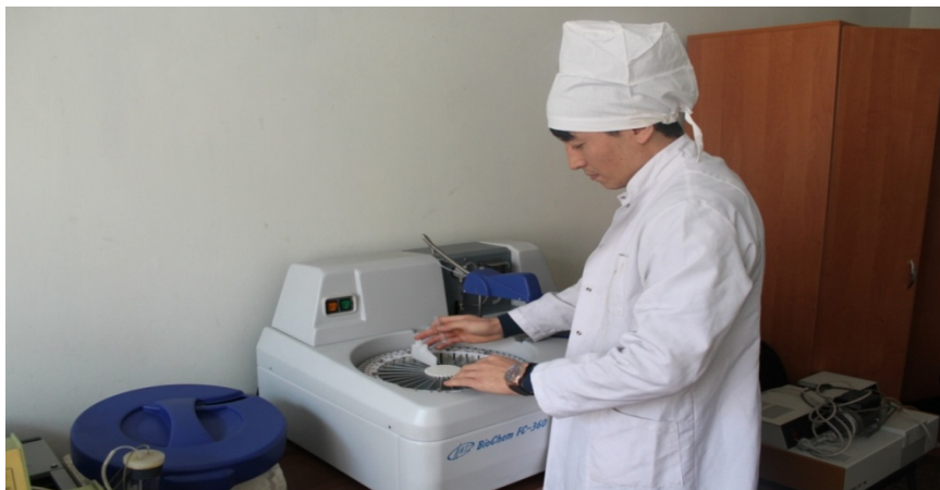
1-сурет – Biochem FC-360 (USA) биохимиялық анализаторында қан плазмасынан жалпы ақуыз, альбумин мөлшерін анықтау жұмысы
