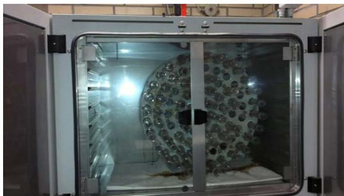
Рисунок 2 – Ферментационная камера «Хоэнхайм» системы тестирования выхода биогаза
