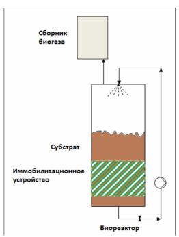
Рисунок 1 – Схематический рисунок биореактора
