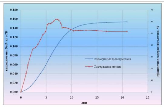
Рисунок 3 – Общий средний совокупный выход метана и содержание метана по второму запуску
