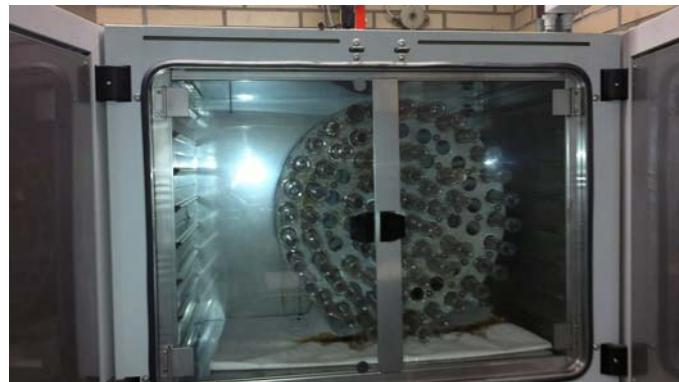
Рисунок 2 – Ферментационная камера «Хоэнхайм» системы тестирования выхода биогаза
